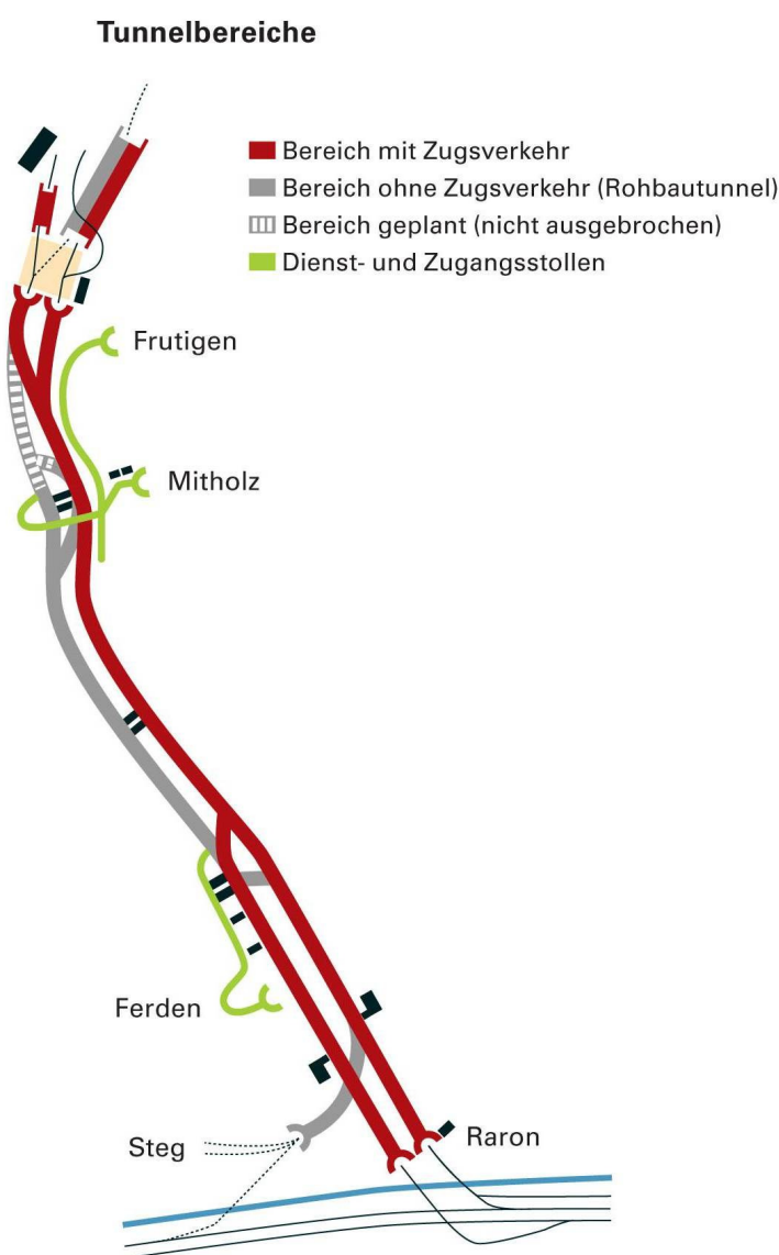
Abb. 1: Schema aktueller Ausbaustand des Lötschberg-Basistunnels
